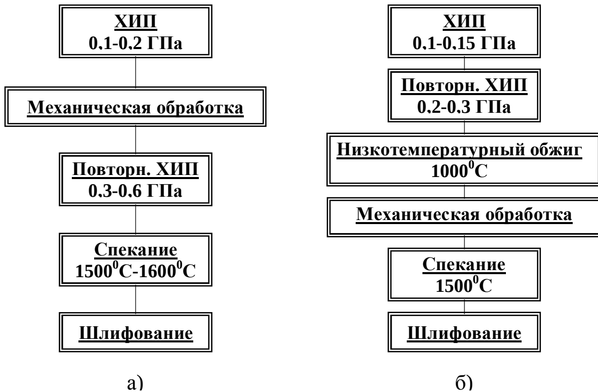
Рис.5. Схема изготовления керамических изделий из порошка диоксида циркония с высокой прочностью связи между частицами – а; с низкой прочностью связи между частицами – б.
